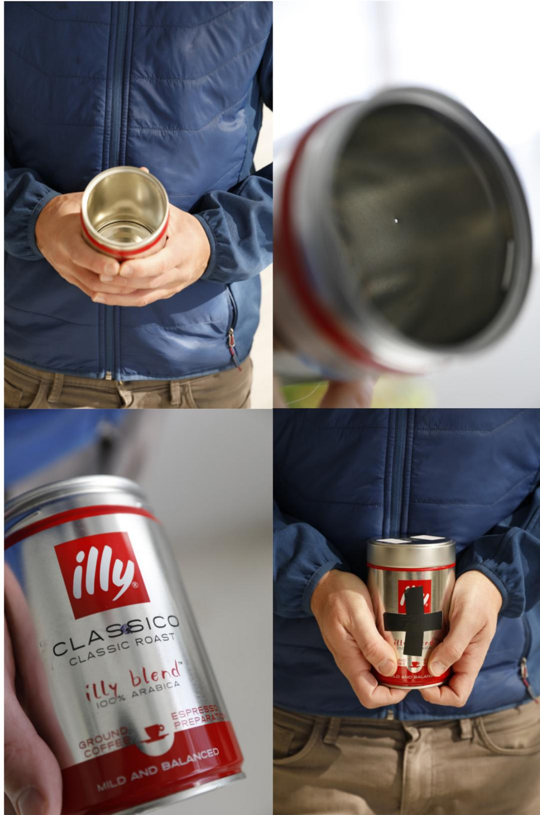
En la cámara oscura, la formación invertida de la imagen es consecuencia de la propagación rectilínea de la luz.
